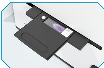
Einsetzen der Objektträgerhalterung in das digitale Scan-Analysegerät. Anschließend kann der Scan-Vorgang gestartet werden
